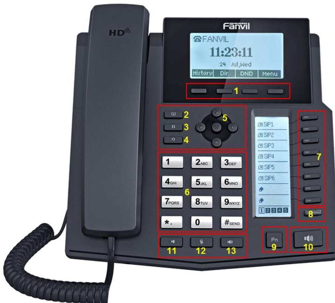
Partes básicas del Teléfono IP
