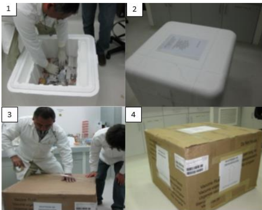
Fig. 13. Acondicionamiento de muestras para envío a laboratorio: 1. Acondicionar debidamente las muestras con geles refrigerantes para que se mantengan conservadas durante su transporte. 2. La caja de tecnopor que contiene las muestras debe ser sellada y por último esta debe ser sellada con una caja de cartón para finalmente ser enviada al laboratorio de destino (3 y 4).
