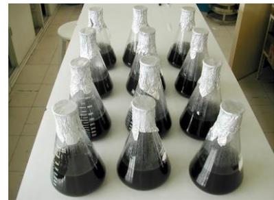
En biofermentadores, en uno de 20 litros, se preparan 15 litros de medio, se esterilizan en autoclave por una hora a 121 °C y 15 lbs de presión. La esterilización se realiza con los filtros cerrando las mangueras con una pinza antes de los filtros, para evitar que se mojen al momento de la esterilización
