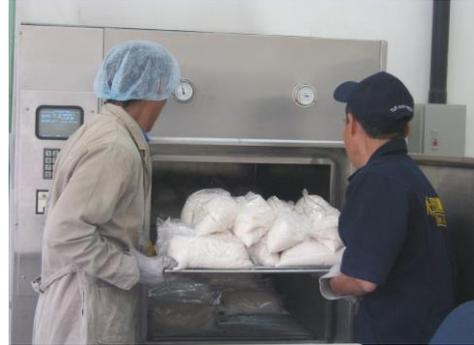
Precaución: Esperar que la presión baje a cero “0” antes de abrir el autoclave.
